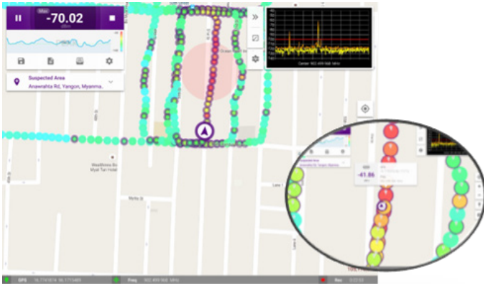
Der InterferenceAdvisor führt den Techniker zum wahrscheinlichen Standort des Störers
