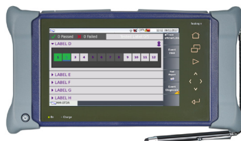
MTS-4000 V2 mit zwei Steckplätzen zum Testen von Glasfasernetzen
