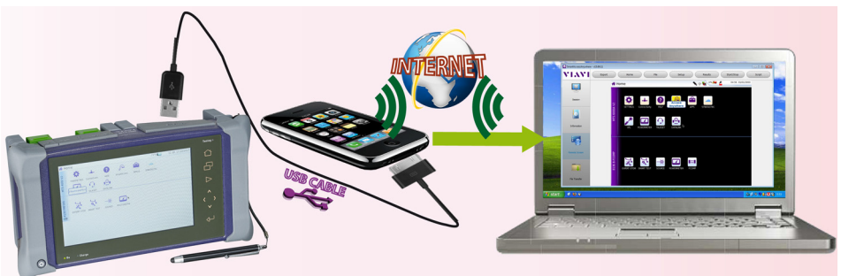
Abb. 48 USB-Verbindung über ein Smartphone
