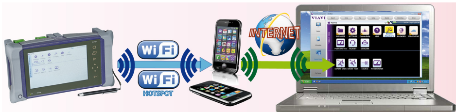
Abb. 49 WiFi-Verbindung über ein Smartphone
