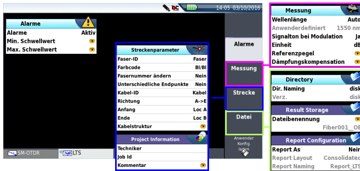
Abb. 13 Konfiguration der Pegelmessung
